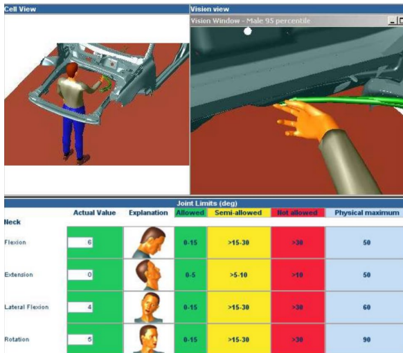
가상 simulation을 통한 작업 자세 평가 (Högberg et al., 2007)
