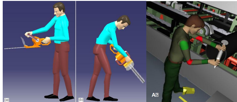
Digital manikin의 작업 자세 simulation (CATIA)
