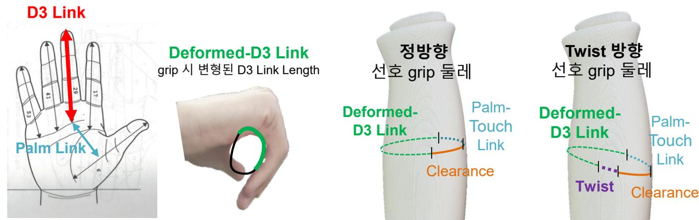
□ 선호된 middle finger point (D3) 둘레(103.7 mm)를 기준으로 손가락 길이 비율 및 차이 data를 적용하여 다른 finger point들(D2, D4, D5)의 grip 둘레 결정
