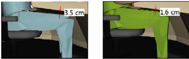
(a) 95 th percentile (b) 99 th percentile 그림 4. Console의 다리 여유공간 분석 결과
