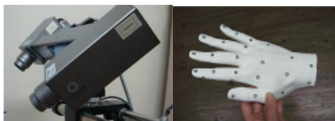
(a) 3D scanner (b) 부착용 marker 그림 3. 3D 손 측정 장비
