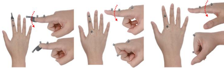
그림3. 손 동작에 따라 부착된 24개의 적외선 반사 marker
