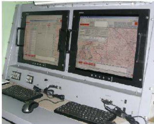
그림 1. 방공레이더 console의 구성 예
