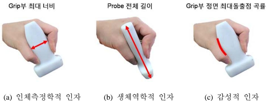
Figure III.5. Linear array probe 설계 인자 유형 분류 예시
