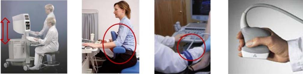
(a) 전동 조정 장비      (b) 팔 지지대      (c) Cable supporter      (d) 인간공학적 probe
