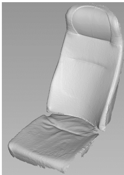
Figure 3.6. 최종 완료된 버스 승객석의 3D 스캔 데이터 예
