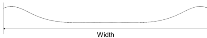
Figure 3.10. 버스 승객석의 너비 측정 방법
